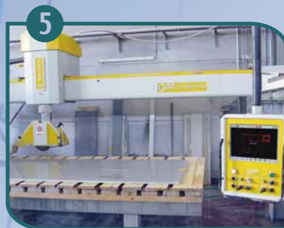
5 La plantilla electrónica se descarga de la máquina de recorte; la cual puede ser: Sierra Cortador de agua CNC
