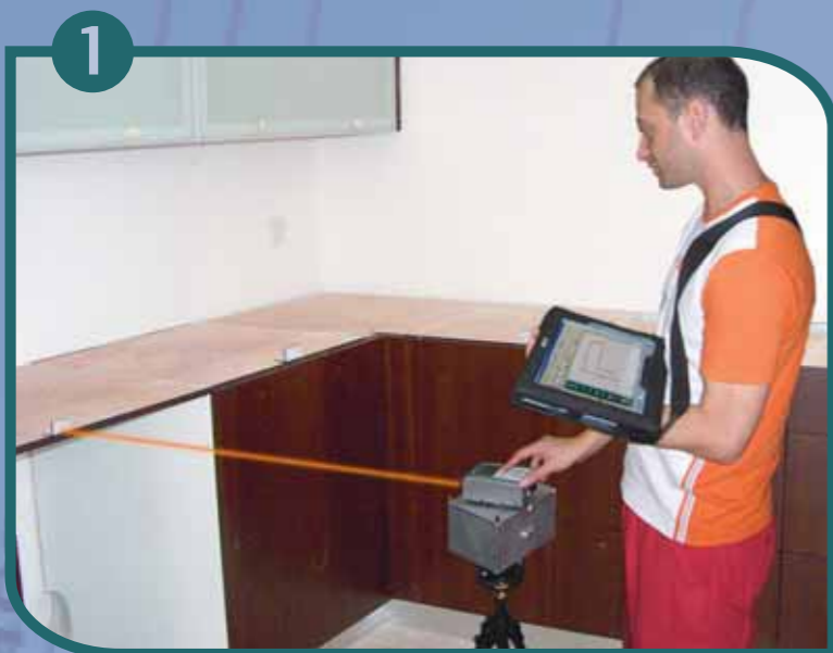
1 El medidor mide y diseña mediante un cómodo "apunte y clic" proceso, utilizando el sistema láser InnoDraw.
